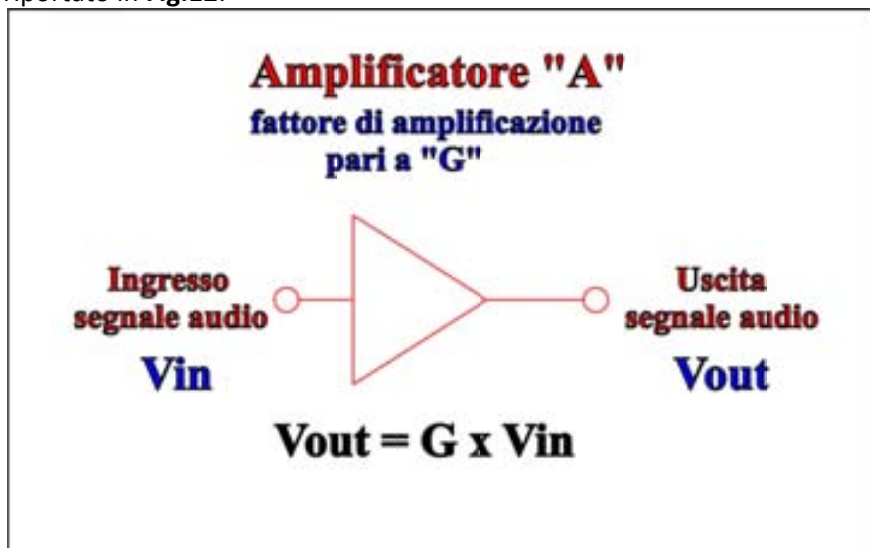
Fig.12: Schematizzazione di un amplificatore caratterizzato da un fattore di amplificazione pari a "G": sono evidenziati il segnale in ingresso, quello in uscita e la loro relazione matematica.
