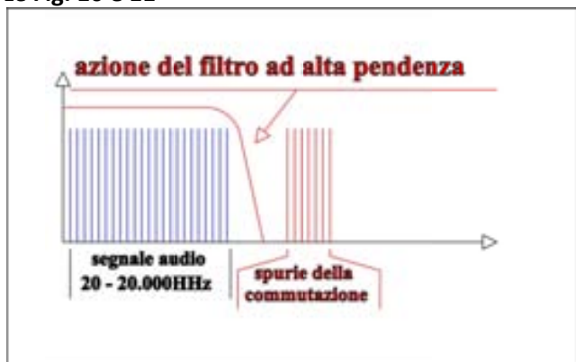
Fig.11: Rispetto alla figura precedente è qui rappresentato il caso di una frequenza di commutazione piuttosto limitata e per evitare i disturbi sull'uscita la pendenza del filtro è stata volutamente accresciuta: questa soluzione tecnica è assai poco adottata in quanto comporta non trascurabili limitazioni alla qualità sonora del sistema.
